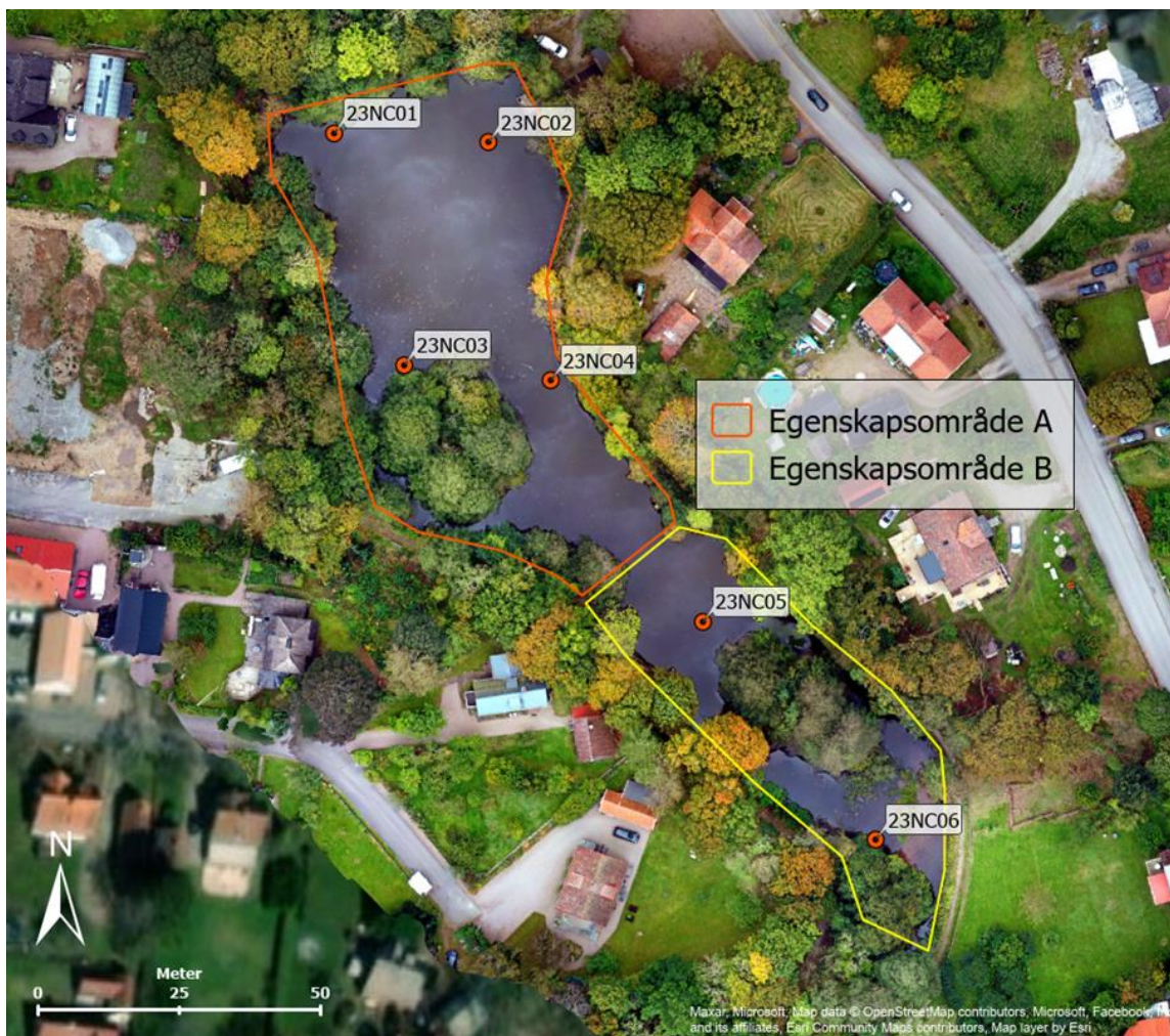
Figur 5-8. Ortofoto över Mölledammen med de sex provtagningspunkterna för sediment utmarkerade tillsammans med indelningen av dammen i två egenskapsområden.
