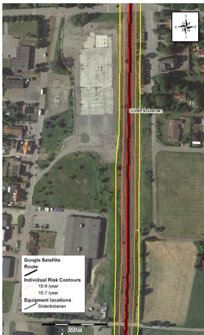
Figur 10. Individriskkonturer (markerad i orange och gult) för transport av farligt gods på Söderåsbanan år 2040 tillsammans med Det Norske Veritas (DNV) riskkriterier, även risk för mekanisk påverkan inkluderas i riskkonturerna. Den röd-svarta linjen representerar järnvägen.
